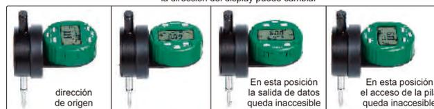
Observación: para girar el display hay que aflojar 4 tornillos de la parte trasera
