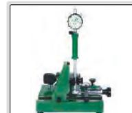
Inspección de alexometro con (rango 18-450 mm)
