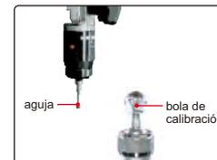
palpador (opcional) incluye bola de ø2mm y ø3mm, bola de calibración con precisión 10µm
