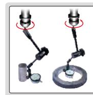
Para medir el centro de los cilindros o orificios en las máquinas
