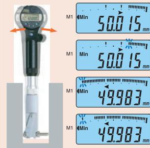
El verificador de interiores Digimatic ABSOLUTE detecta el valor mínimo (diámetro real) y lo mantiene automáticamente.
